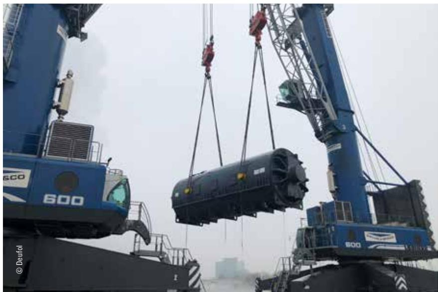
**Deufol besitzt vier nicht schienengebundene Mobilkräne, die sich flexibel auf dem Terminal bewegen und im Tandem bis zu 400 Tonnen Stückgewicht bewegen oder heben können.**
