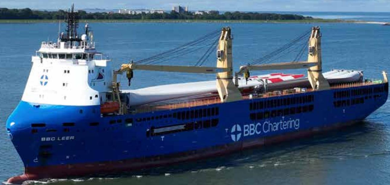
Die BBC LEER ist mit zwei Liebherr-Bordkränen ausgerüstet, die bis zu 500 Tonnen heben können.
